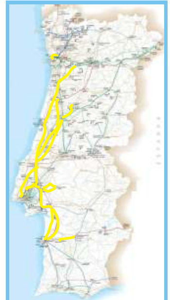
1346km de líneas inspeccionadas (en amarillo) sobre el mapa de la red de transmisión.
